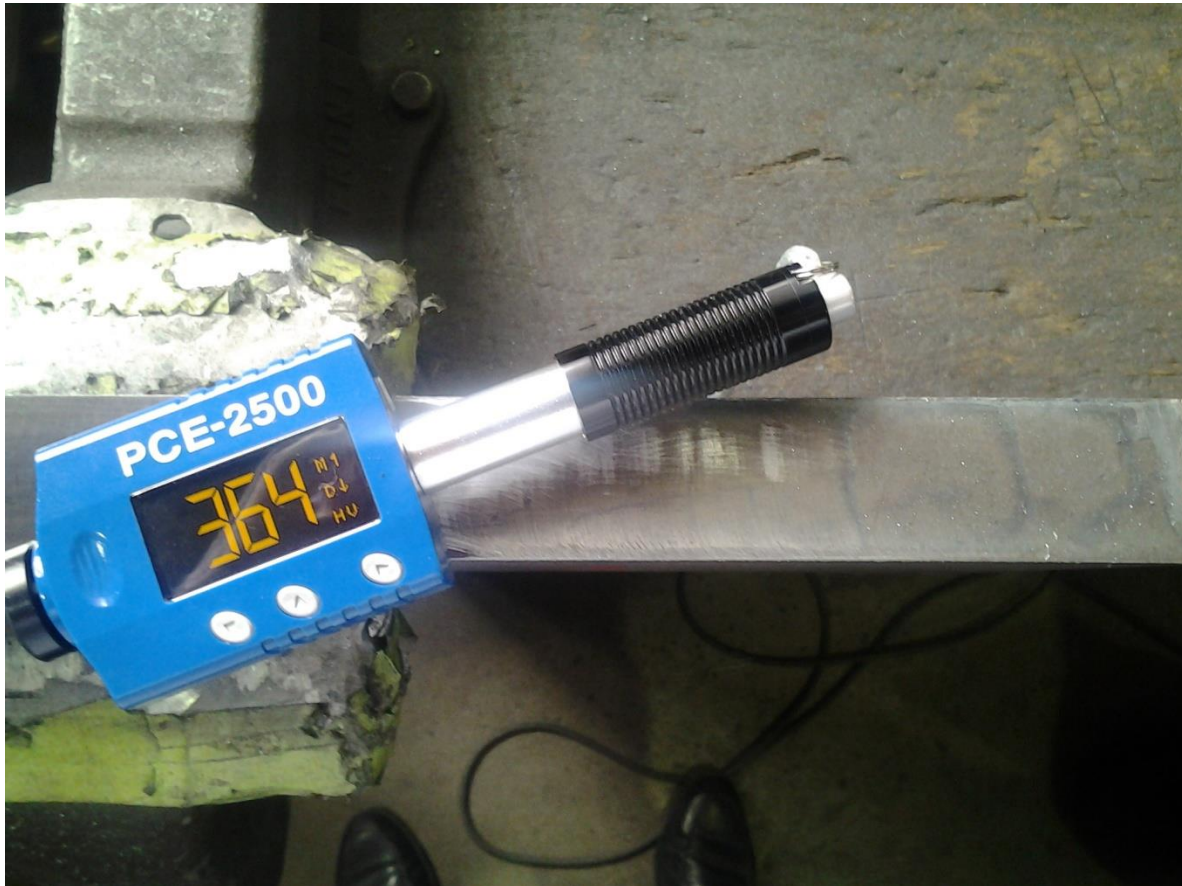
Plasmaschnitt S 355 J2, Blech 30/150.....500 mm
